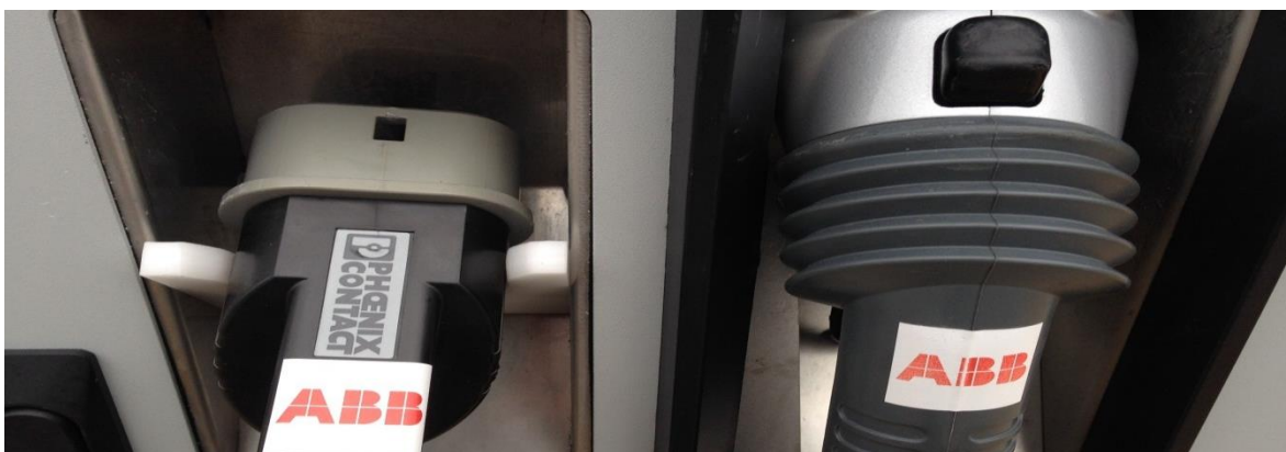
Figur 12: Elbil er foreløpig en ung bransje. Det er mange varianter av ladekontakter og lite standardisering
