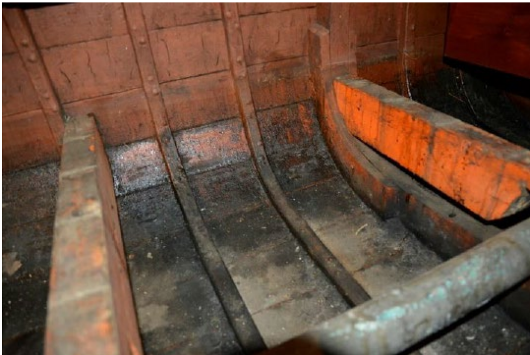
Bilde 21 Ribber, bunnstokk og skjøtestykke styrbord side
