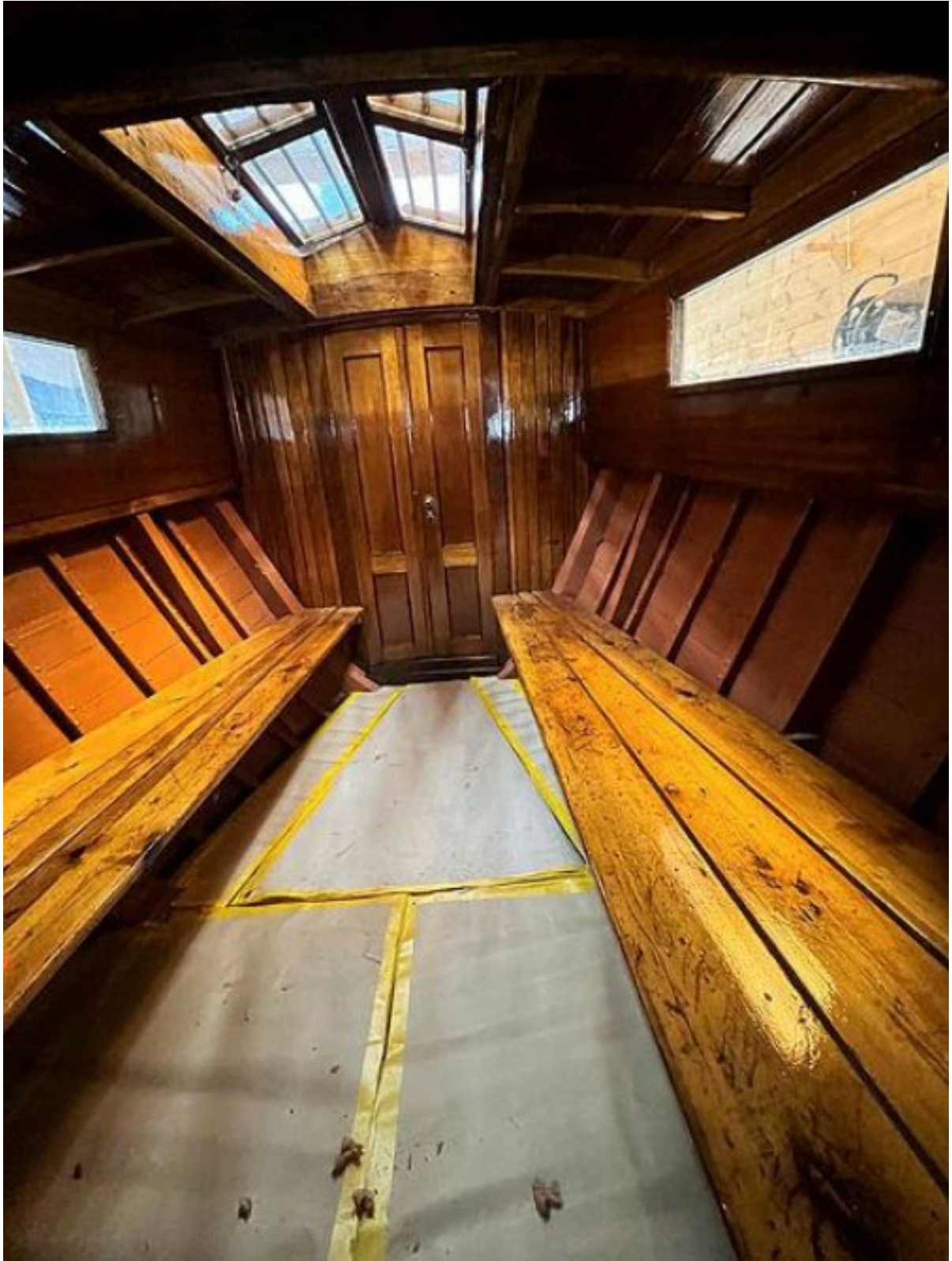
Bilde 49 Detaljer inne i salongen. Skrog er malt i original rustrød farge. Dørken er malt grønn og er montert å plass. er remontert, og skott med dører er ferdig lakkert.
