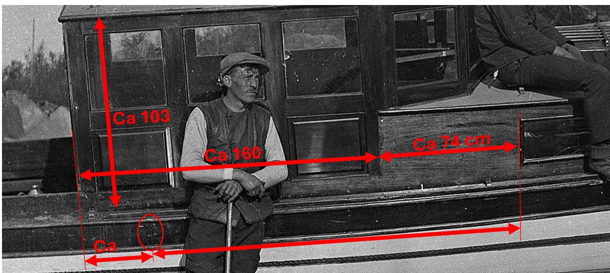
Figur 6. Ved hjelp av kjende avstandar og forholdstal kan også lengda på styrhuset bereknast ganske nøyaktig. Estimert avstand passar svært godt med det som sannsynlegvis er spor etter akterskottet i cockpiten.
