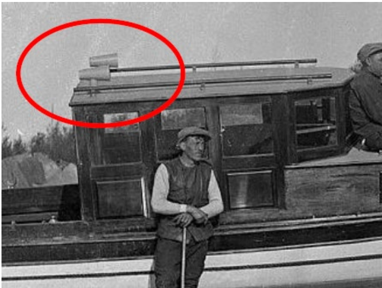
Bilde 8 To stk ventiler på taket
