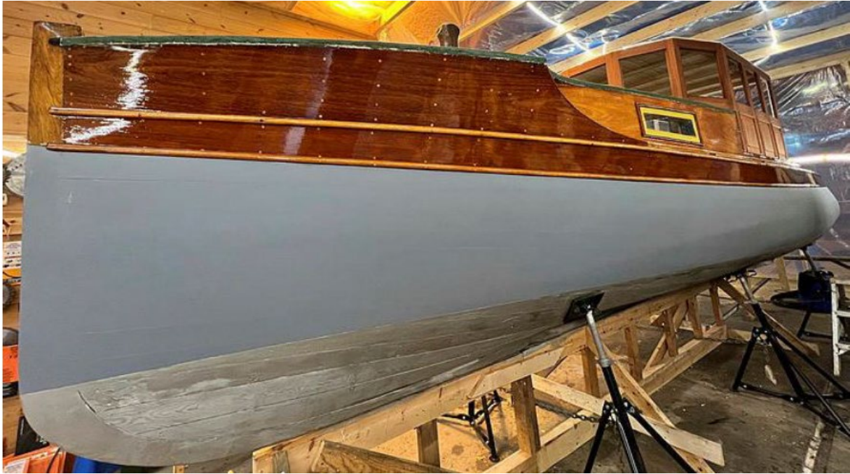
Bilde 42 Vannlinje laget med et spor risset inn i huden. Huden under vannlinje er impregnert, primet, og grunnet. Fribord lakker første strøk.
