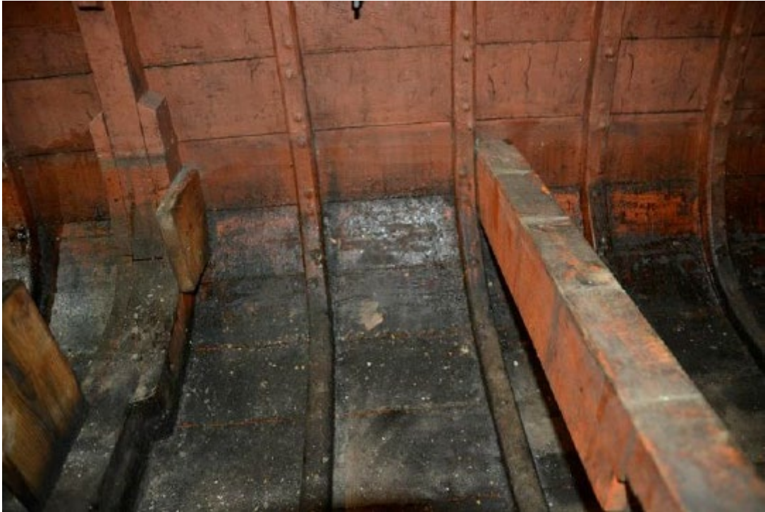
Bilde 22 Ribber, bunnstokk og skjøtestykke babord side
