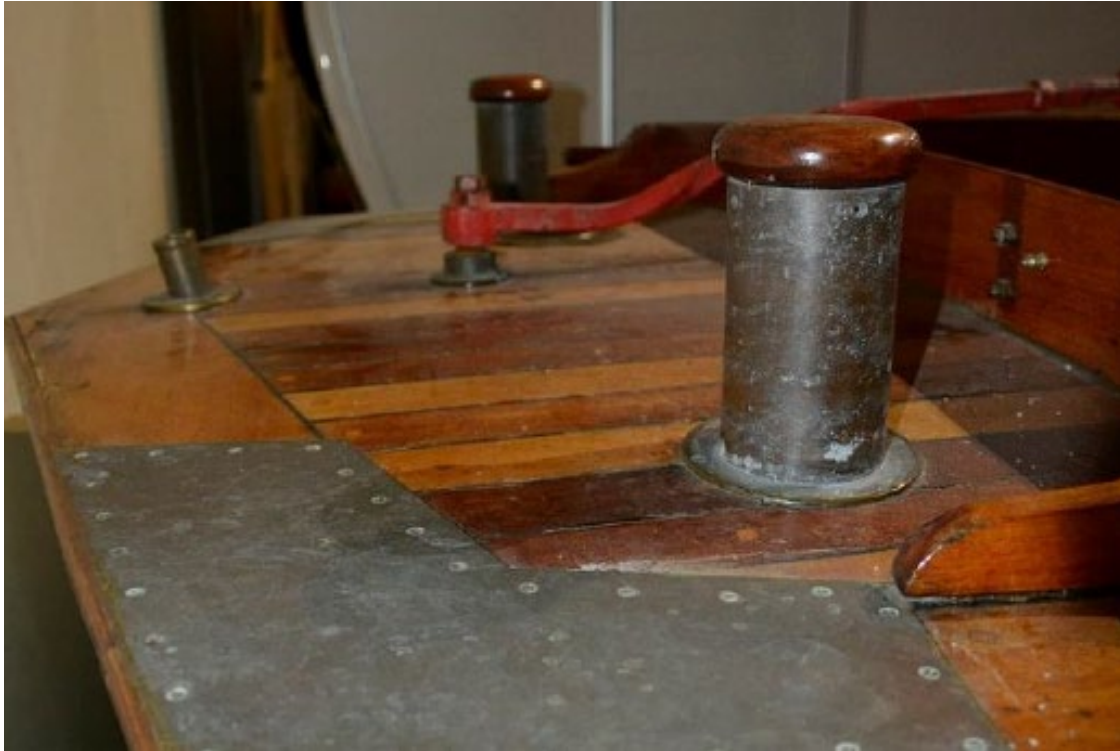
Bilde 18 Nye pullerter på akterdekket
