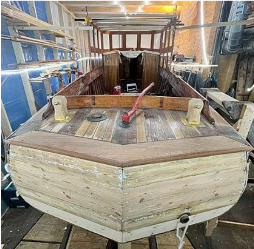
Bilde 37 Her er konstruksjonen bjelker på plass
