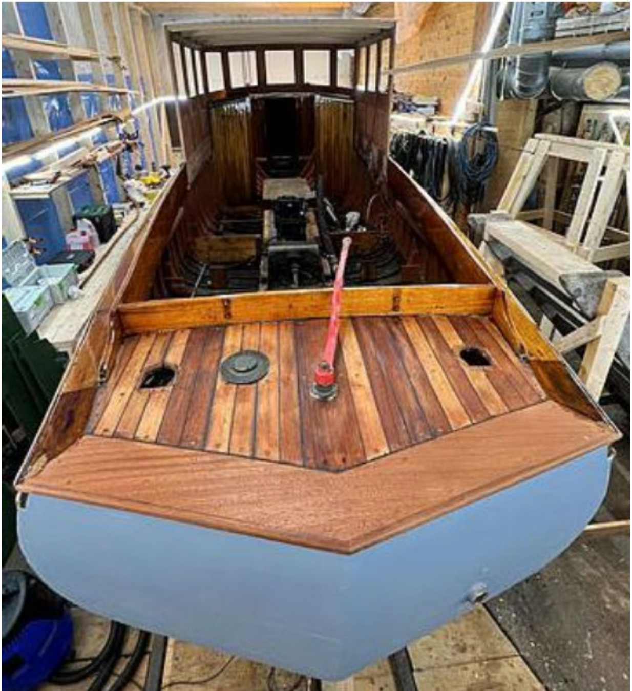
Bilde 46 Lakkering av skandbord og akterdekk
