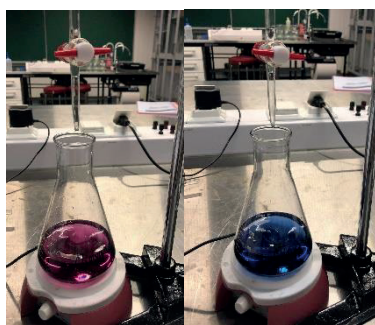
Figur 4 Vannprøve fra Mjøvann, før og etter titrering
