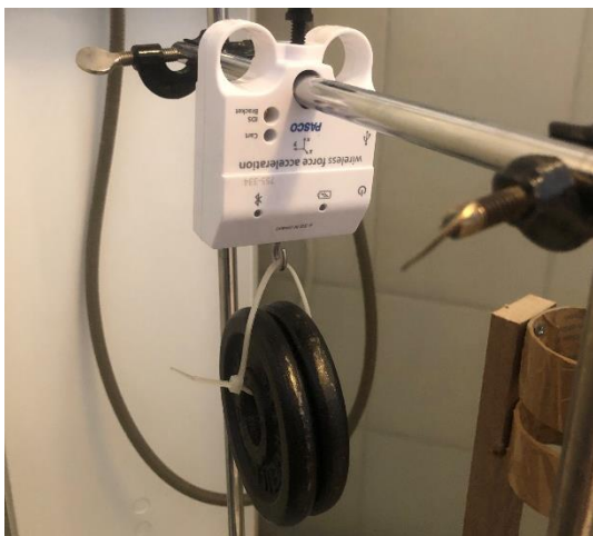
Figur 3-5: Bilde av kraftmåler under kalibrering.
