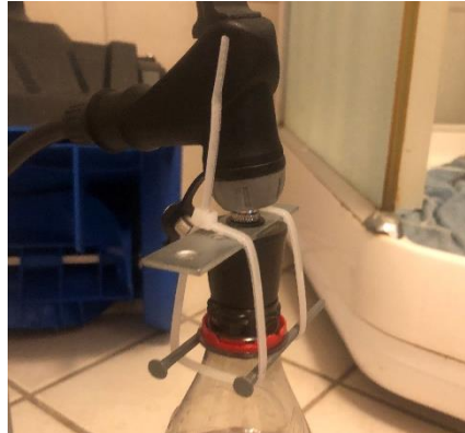
Figur 3-3 Utskytningsmekanismen er festet og raketten tilføres luft.
