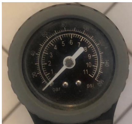
Figur 6-1: Manometeret til pumpa.
